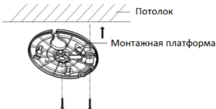
Рисунок 2-3 Установка монтажной платформы
